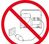
Agregata nikoli ne priklapljajte v inštalacijo, ki je povezana z javnim dovodom elektrike. Neustrezna povezava z električni sistemom zgradbe lahko povzroči povratno napetost v daljnovodih. To lahko ubije delavca elektro podjetja ali kogarkoli, ki bi se dotikal žic v času izpada elektrike, ob povrnitvi električne energije pa lahko povzroči požar ali eksplozijo aggregata. Za pravilno povezavo se posvetujte z lokalnim elektro podjetjem ali kvalificiranim elektro inženirjem.
