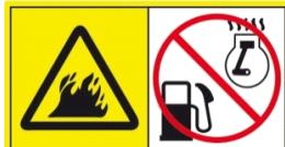
Gorivo je izjemno vnetljivo in eksplozivno in lahko povzroči opekline ali druge poškodbe, če ob dotakanju niste previdni. Pred točenjem goriva vedno izključite motor in pustite, da se prej ohladi.
