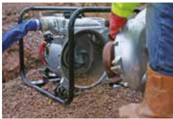
Snemljiv pokrov za pregled omogoča hiter in enostaven dostop
